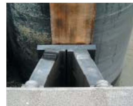
▲ UE-V fender pontoon pile guide
